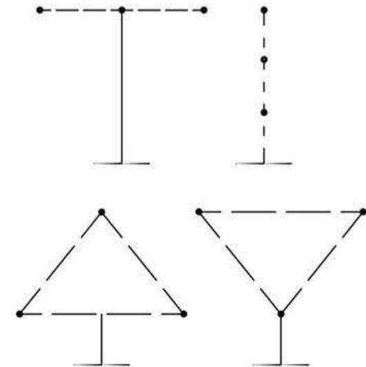
При размещении на одной опоре знаков одной группы очередность их расположения определяется номером знака в группе.
