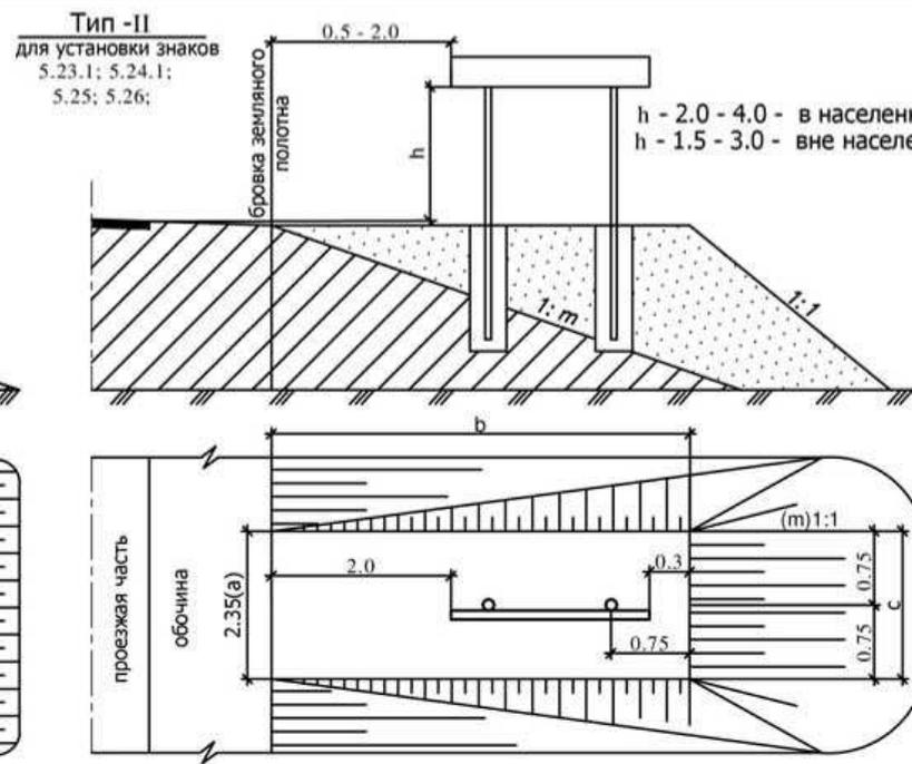
**Конструкция фундамента под металлические стойки опор дорожных знаков**
