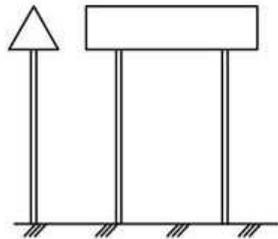
Верхний обрез фундамента опоры знака должен быть заподлицо с поверхностью присыпной бермы или земли.
